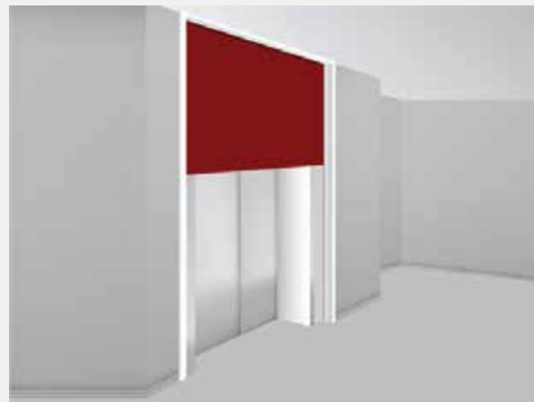
CÁC GIẢI PHÁP CUỐN SẬP CHỐNG CHÁY E CHO THANG MÁY
